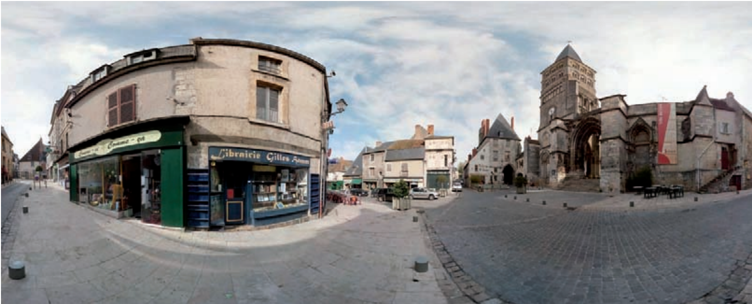
Sphärische Projektion eines 360° x 180°-Panoramas auf eine Fläche. Diese Form der Darstellung wird auch als Equirectangular bezeichnet.
