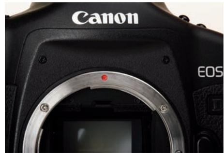
*Hier darf kein EF-S-Objektiv angesetzt werden! Am Gehäuse dieser Canon 1D Mark II ist lediglich ein roter Punkt zu sehen. Die Kamera ist also nur für EF-Objektive geeignet.*
