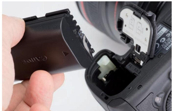
*Die Form des Akkus bestimmt, wie er ins Kameragehäuse gesteckt werden muss. Um den Akku zu entnehmen, müssen Sie das Akkufach einfach öffnen und den weißen Schnapper entriegeln – der Akku springt dann aus seinem Fach.*
