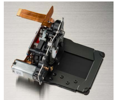
⌘ Schlitzverschluss der Nikon D5300 (Bild: Nikon)
