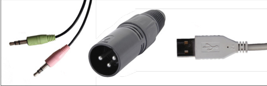
Abb. 2.9: Miniklinke (Durchmesser 3,5 mm), XLR und USB
