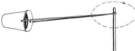
Wenn sich der Becher mit hoher Geschwindigkeit auf einer Kreisbahn bewegt, wirkt eine starke Fliehkraft. Sie sorgt dafür, dass die Flüssigkeit im Becher bleibt.
