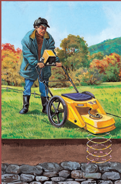
Das Bodenradargerät sendet elektromagnetische Wellen aus, die an im Erdreich verborgenen Objekten zurückprallen.
