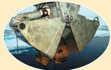
Häufig werden Sedimentproben mit dem Kastengreifer genommen.
