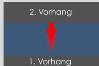
▲ Beim Schlitzverschluss saust der erste Vorhang los, gefolgt vom zweiten Vorhang. Die Schlitzbreite ändert sich abhängig von der gewählten Verschlusszeit. Je länger die Zeit, desto größer der Schlitz.
