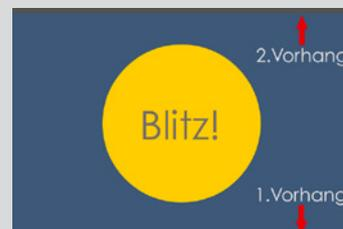
▲ Erst nachdem die gesamte Sensorfläche durch die Verschlussvorhänge vollständig freigegeben wurde, wird der Blitz synchron gezündet.
