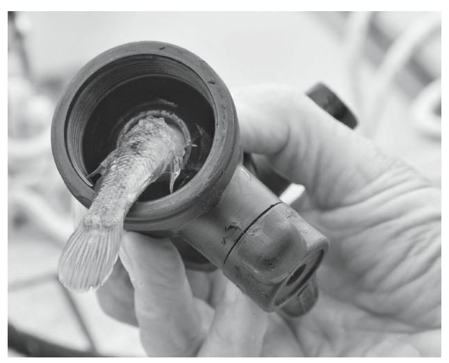
EIN FISCH IM KÜHLWASSER. DAS IST MAL WAS NEUES. HARTMUT, DER UNS HILFT, SCHIMPFT: »WIE KANN MAN NUR EINE ANSAUGLEITUNG OHNE SIEB INSTALLIEREN?«
