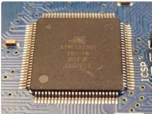
Bild 3.2: Ein Mikrocontroller in SMD-Form.
