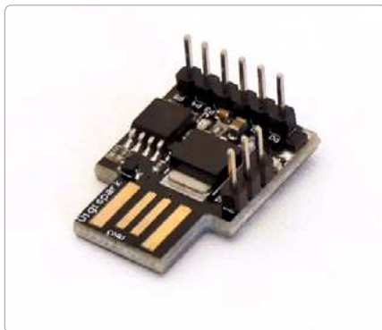
Bild 3.11: Der Digispark rev3 – ein Arduino-kompatibles Board in Mini-Größe.
