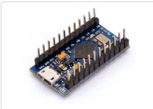
Bild 3.10: Der Arduino Pro Micro – ein Board so groß wie eine Streichholzschachtel.
