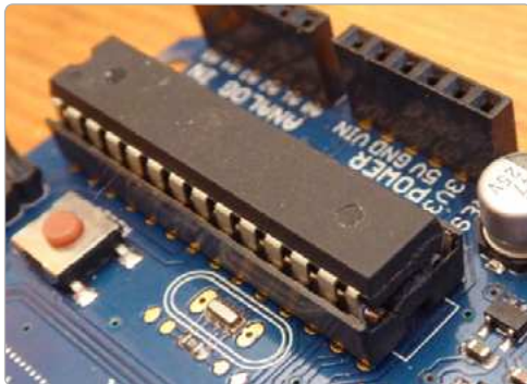
Bild 3.1: Ein steckbarer Mikrocontroller in DIP-Bauform.
