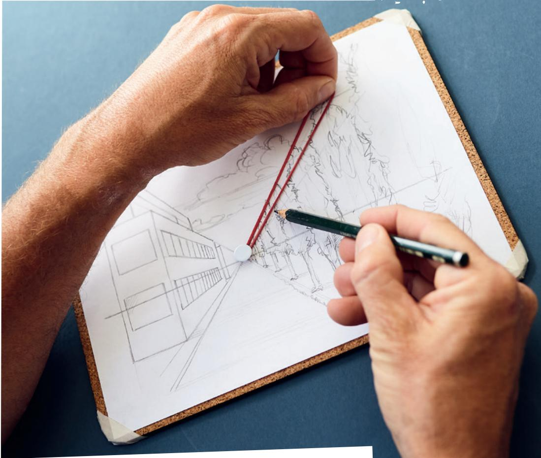
**Im Gegensatz zur Zweipunktperspektive fluchten die im Raum nach hinten verlaufenden Linien hier nur in einem Punkt. Diesen Fluchtpunkt kannst du mit einer Reißzwecke festlegen und das Gummiband daran befestigen. Generell bleiben alle senkrechten Linien weiterhin senkrecht und alle waagrechten Linien waagrecht.**
