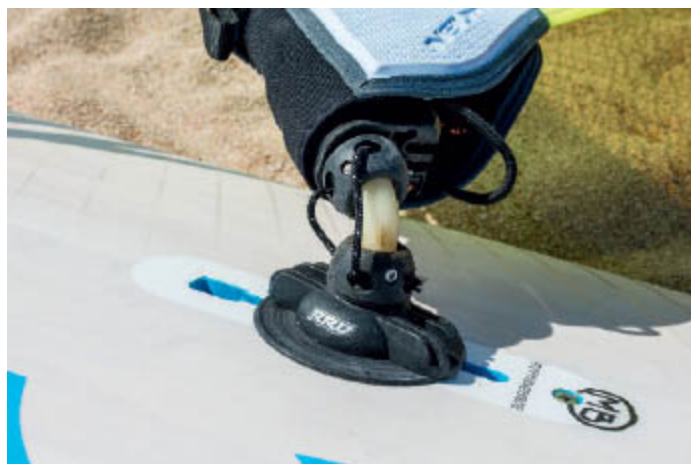
Mastfuß: Gummiverbindung zwischen Brett und Segel, die in der Mastschiene des Boards festgedreht und in die Mastverlängerung gesteckt wird.
