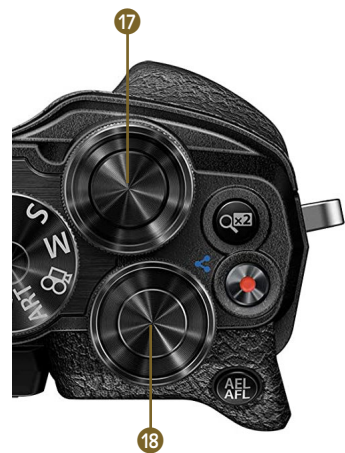
Abbildung 1.6: Der Auslöser 17 kann unter Umständen mit der ähnlich aussehenden Erhebung 18 am hinteren Einstellrad verwechselt werden. (Bild: Olympus)
