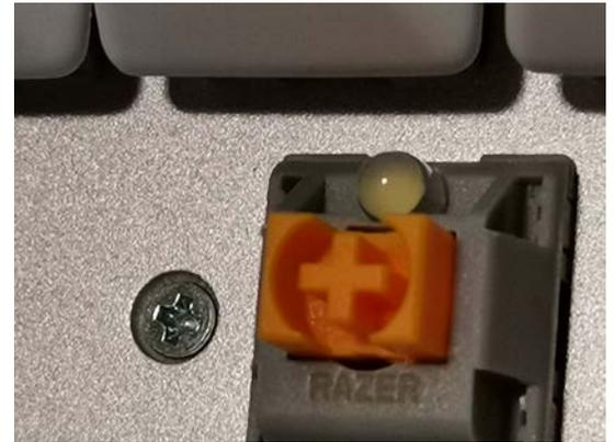
**Farbcodierungen der Hersteller kennzeichnen die Schaltcharakteristik mechanischer Tasten. Die Razer Orange beispielsweise hat einen Druckpunkt.**
