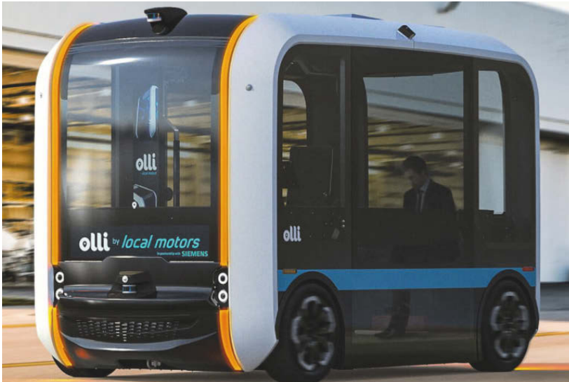
Abb. 1.1: Kfz aus dem 3D-Drucker von Local Motors
