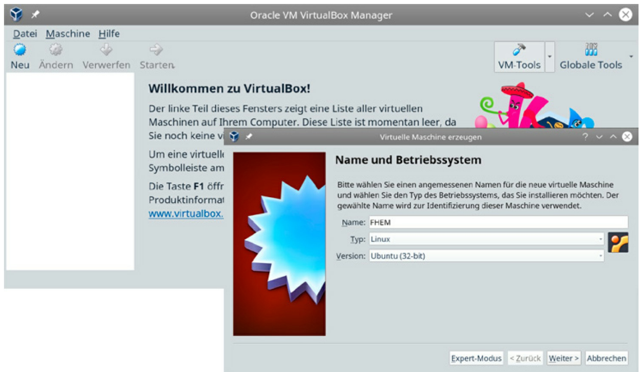
Bild 2.1 Anlegen einer neuen virtuellen Maschine in VirtualBox
