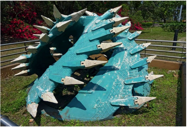
Bohrkopf eines alten «Bohr-Saugbaggers», Chep Lap Kok, Hongkong.
