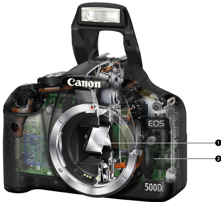
⤴ Das Herzstück einer digitalen Kamera ist der im Inneren verbaute Bildprozessor ❷. Gut zu erkennen ist der für eine Spiegelreflexkamera charakteristische Spiegel in der Bildmitte ❶ (Bild: Canon).
