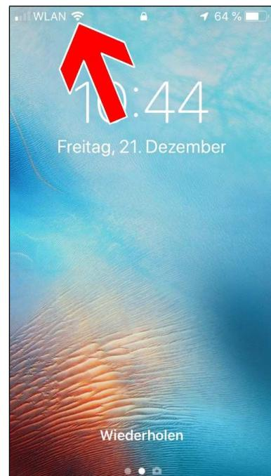
Auf allen Handys wird der WLAN-Empfang mit Balken angezeigt (Pfeil), was Ihnen bei der Suche nach einem optimalen Aufstellort für Ihr Echo-Gerät hilft.
