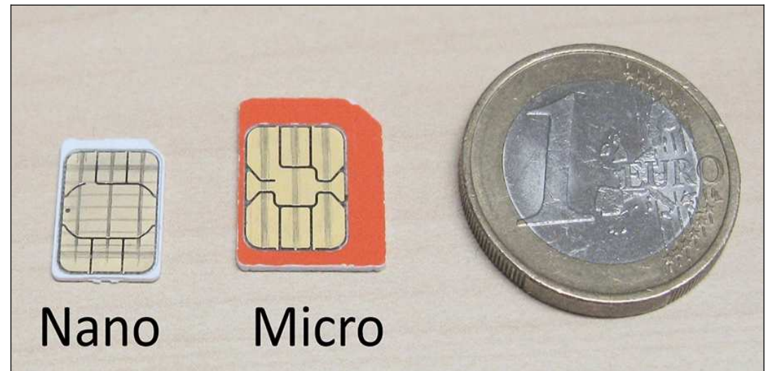
Nano- und Micro-SIM-Karte im Größenvergleich mit einer Euro-Münze.
