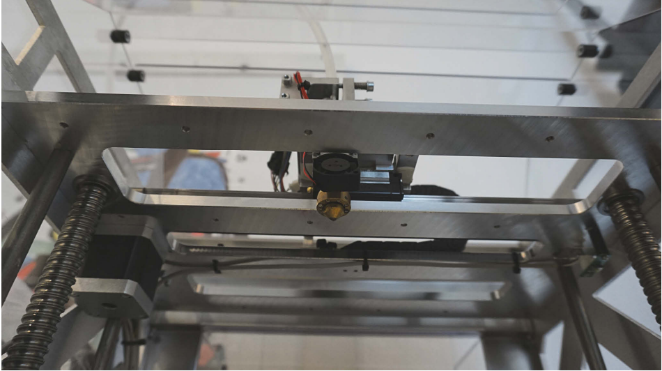
Abb. 2.4: Die Druckdüse (Extruder)
