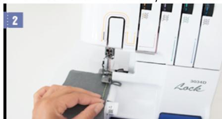
2. Nähe 1–2 cm, bis du die Fadenkette greifen und nach vorn unter den Nähfuß legen kannst. Sie liegt nun auf der Nahtlinie.
