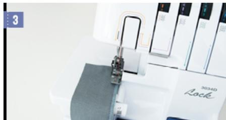
3. Nähe nochmals 3–4 cm auf der bisherigen Nahtlinie, ohne die eben gemachte Naht zu zerschneiden. Lass die Naht nach rechts auslaufen, indem du den Stoff während des Nähens nach links aus der Maschine ziehst, verknote die Fadenkette und schneide überstehende Enden ab.
