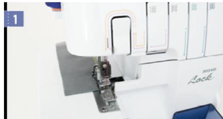
1. Nähe am Ende einer Naht einen Stich über den Stoff hinaus und halte die Maschine an.
