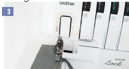
3. Nähe über die Fadenkette drüber, ohne sie zu zerschneiden. So wird sie in die Naht mit integriert.
