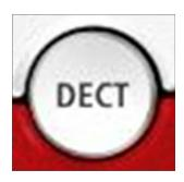
Eine andere Funktion der *DECT*-Taste ist der Suchruf für Mobilteile: Sollten Sie ein Mobilteil verlegt haben, drücken Sie kurz auf die *DECT*-Taste. Dann klingeln alle angemeldeten Mobilteile mit ihrem Standardklingelton. Ein erneuter Druck auf diese Taste oder eine beliebige Taste an einem Mobilteil beendet den Suchruf.
