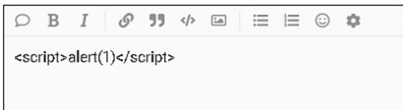
**Abbildung 2.5** Versuch einer Cross-Site-Scripting-Attacke
