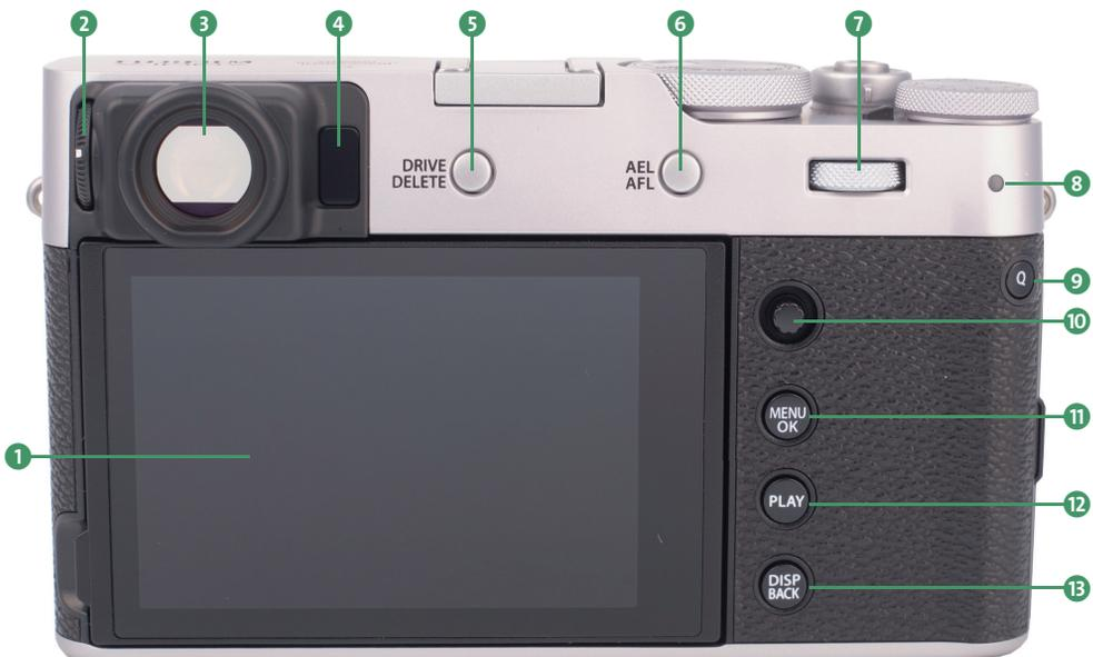
Abbildung 1.2 Die Fujifilm X100V von hinten
