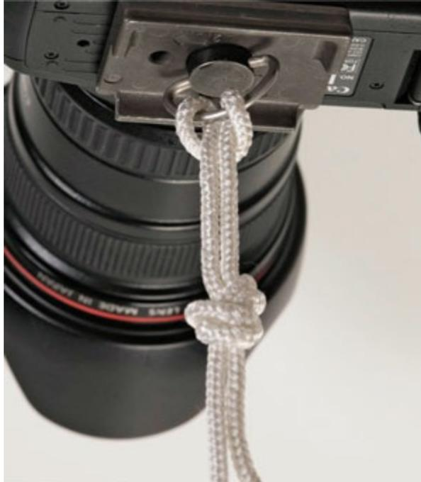
Ein Fadenstativ kann man, siehe die Abbildung rechts, um das Objektiv legen. Die etwas elegantere Lösung besteht in einer Stativschraube mit Öse, wie sie zu einigen Wechselplatten gehören.
