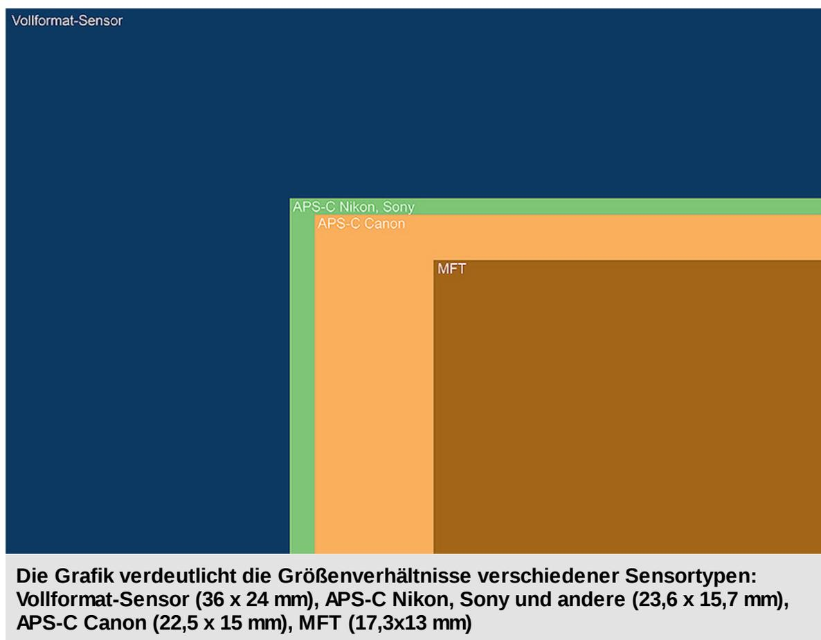
Smartphonekameras und Kompaktkameras haben noch kleinere Sensoren. Gerade Erstere nutzen daher viel Computertechnologie, um diesen Umstand auszugleichen und ein Resultat zu erzeugen, das einem größeren Sensor nahekommt (z. B. künstliche Hintergrundunschärfe). Dafür berechnen sie mit teils komplizierten Techniken das fertige Bild. Dadurch ist ein Smartphonefoto mehr „künstliche Intelligenz“ und weniger „traditionelle Fotografie“. Dies führt dazu,
