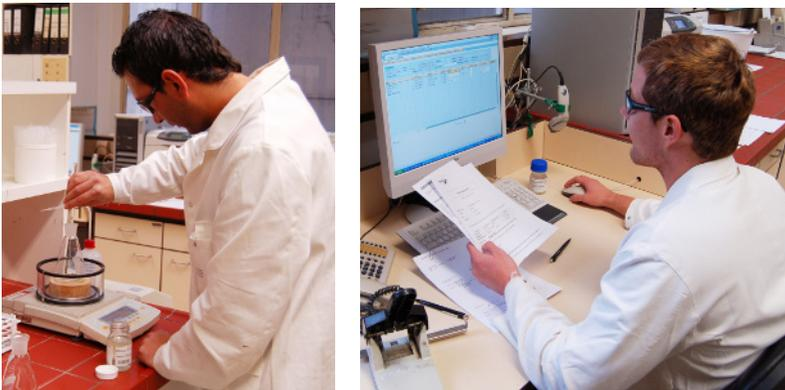
Abb. 1.1: Qualitätskontrolle bei der Tensideherstellung (Säurezahlbestimmung und Eingabe für die statistische Auswertung); Quelle: Evonik Industries AG, Essen
