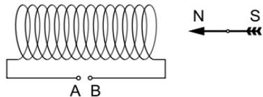
*Lösung:* Dem Nordpol der Magnetnadel muss ein Spulensüdpol gegenüber liegen. Daher muss am linken Spulenende ein Nordpol liegen. Nach der Rechte-Hand-Regel ist dies der Fall, wenn B mit dem Pluspol und A mit dem Minuspol der Gleichspannungsquelle verbunden wird.
