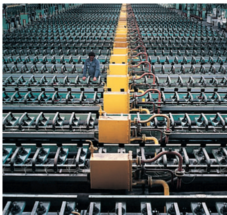
Chlor-Gewinnung in einer chemischen Fabrik mithilfe des elektrischen Stroms
