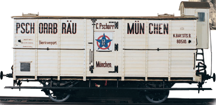
Wegen des weißen Außenstrichs heizte sich der Kühlwagen nicht so schnell auf.
