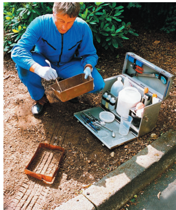
Sicherstellen einer Reifenspurr durch einen Gipsabdruck
