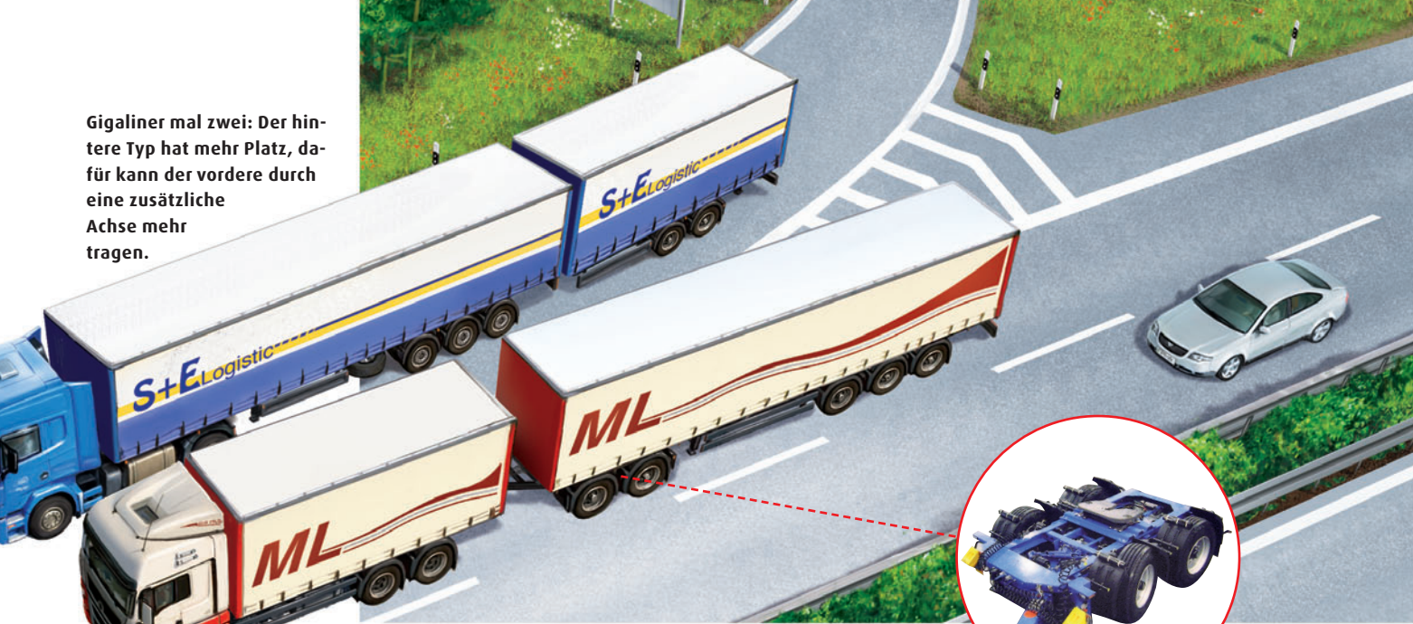
Der Dolli, ein kleiner Anhänger mit Sattelplatte, trägt und zieht den Auflieger.
